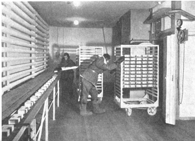
Bild 1 oben: Transportable Gefrieranlage, welche zur Erntezeit in die Anbaugelände führt, um die frisch gewonnenen Früchte oder Gemüse an Ort und Stelle zu konservieren. (Aufnahme Birds Eye, Zürich)
