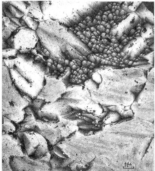
Bild 8: Gefügebild einer Hydronalium-Oberfläche (Aluminium-Magnesium-Legierung) (Lack-Abdruck, Vergrößerung 4500:1)
