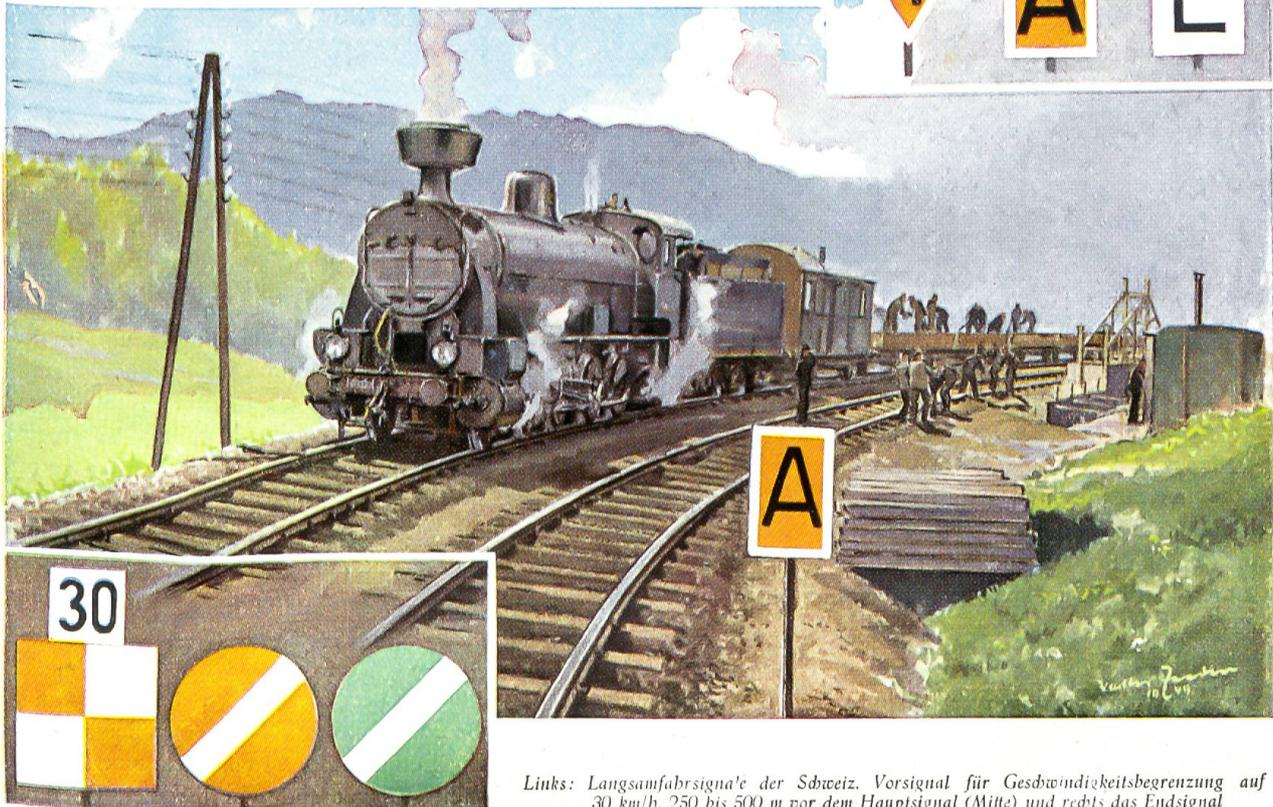
Links: Langsamfahrtsignale der Schweiz. Vorsignal für Geschwindigkeitsbegrenzung auf 30 km/h. 250 bis 500 m vor dem Hauptsignal (Mitte) und rechts das Endsignal
