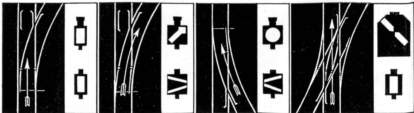
Einfache Weiche geradeaus    Einfache Weiche ablenkend nach rechts    Einfache Weiche ablenkend nach links (von rückwärts gesehen)    Doppelte Kreuzungsweiche geradeaus für das Gleis in Hauptrichtung (von rechts nach links)
