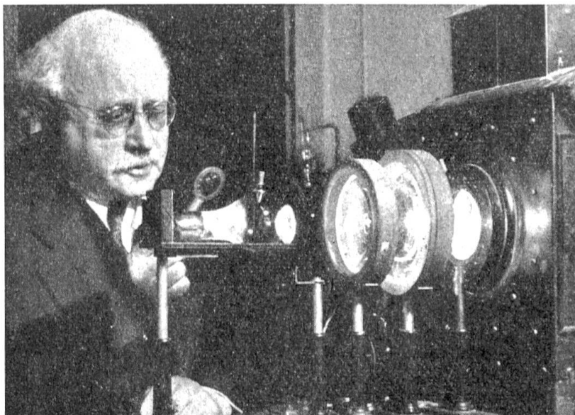
Abb. 1. Prof. Ehrenhaft, der Entdecker der Photophorese, bei Versuchen mit künstlichen Lichtquellen im Physikalischen Institut in Wien. Prof. Ehrenhaft beobachtet eine Kreisbahn mit der Lupe. Rechts im Bilde die beiden Linsen, die den Lichtstrahl konzentrieren
