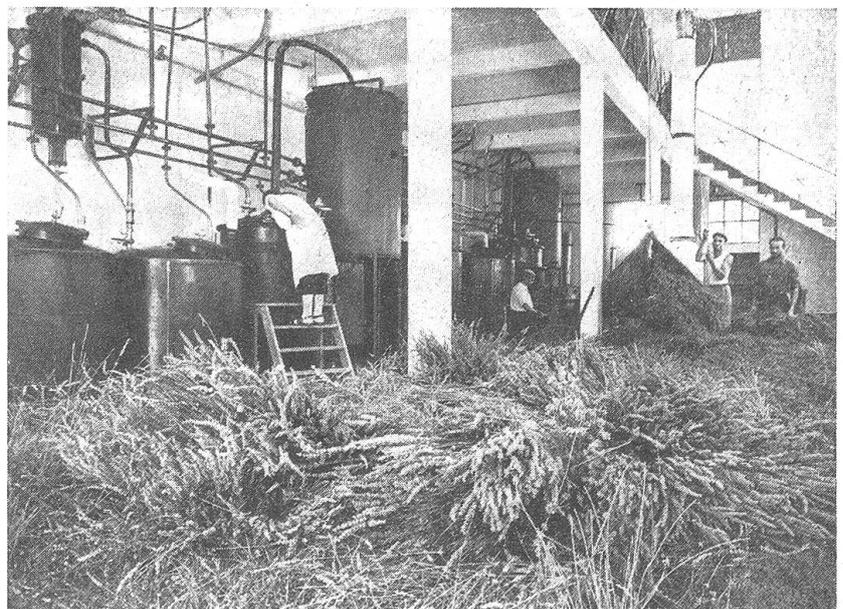
Abb. 3. Der Extraktionsraum einer Parfümessenzfabrik in Grasse, wo sogenannte „concrètes“ durch flüssige Lösungsmittel, wie Aetherpetrol oder Benzin, gewonnen werden. Die am Boden bereitliegenden Pflanzen sind Lavendel
