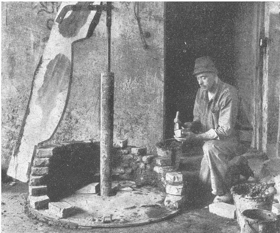
Das Aufmauern des Glockenkernes. Links steht schon die drehbare Schablone bereit, mit deren Hilfe das Äußere des Kernes genau profiliert wird
