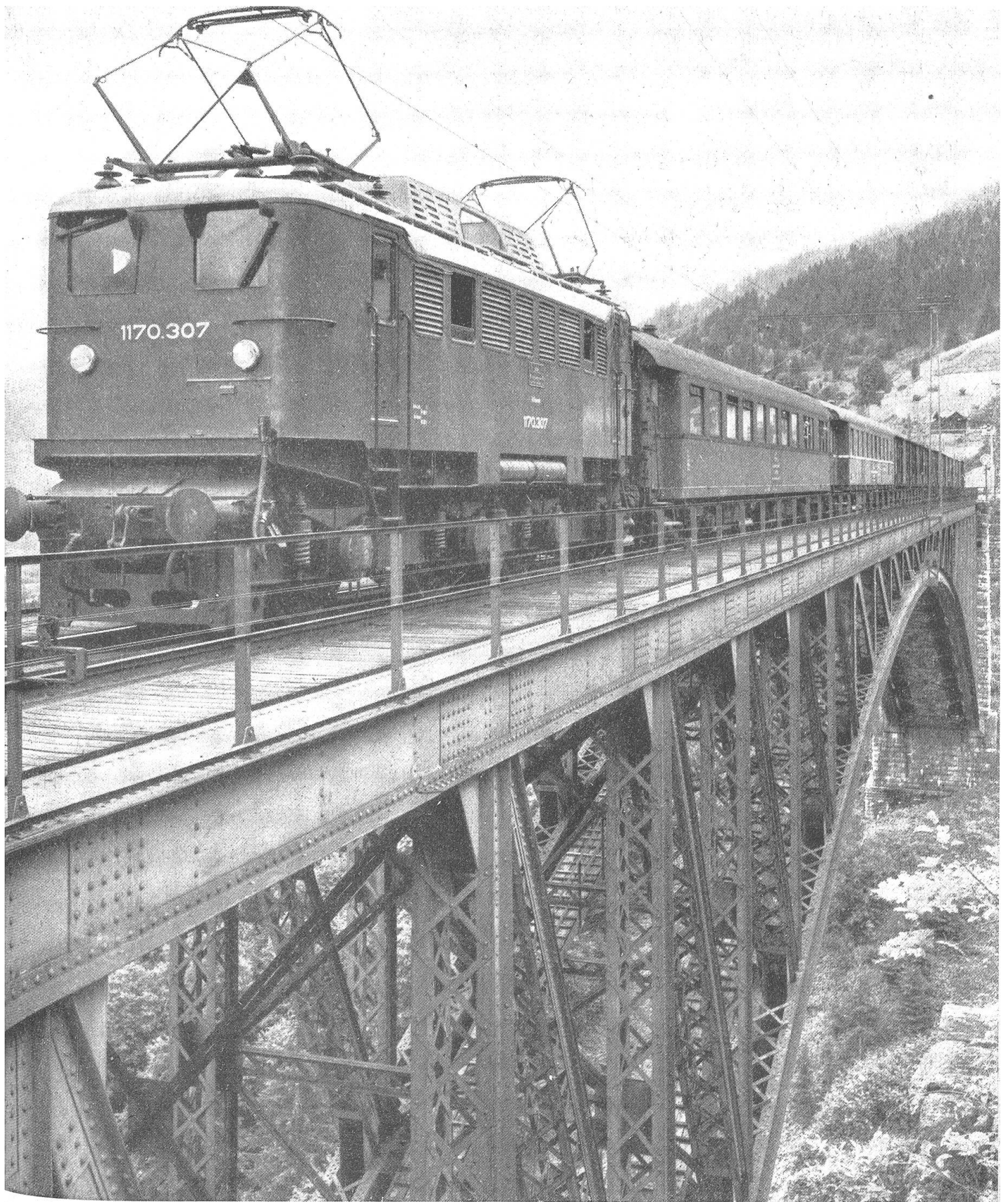
Abb. 18. Sowohl für die Personen- und Schnellzugsförderung, wie auch für den Güterdienst ist diese Universal-Elektrolokomotive verwendbar, die seit 1951 von den österreichischen Bundesbahnen verwendet wird und von der Firma Elin gebaut wurde. Gesamtleistung 3200 PS, Maximalgeschwindigkeit 90 km pro Stunde
