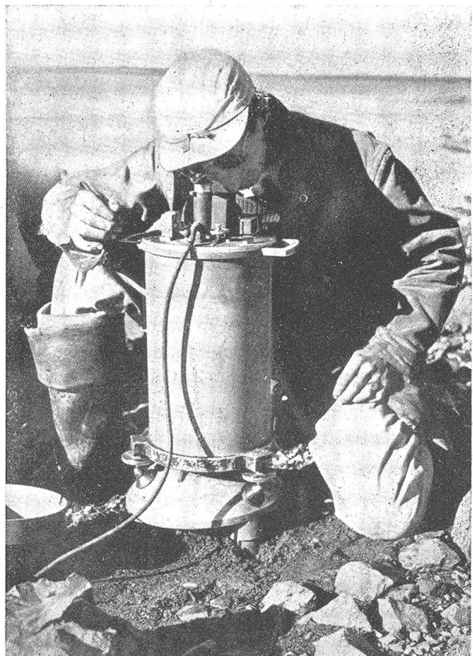
Abb. 1. Gravimeter im Feldebetrieb: Der Eisenmantel birgt den Thermostaten, das empfindliche Federmeßwerk und die photoelektrische Einrichtung, mit deren Hilfe Federdehnungen von einem Tausendstel bis zu einem Millionstel Millimeter am Galvanometer zum Ausdruck kommen
