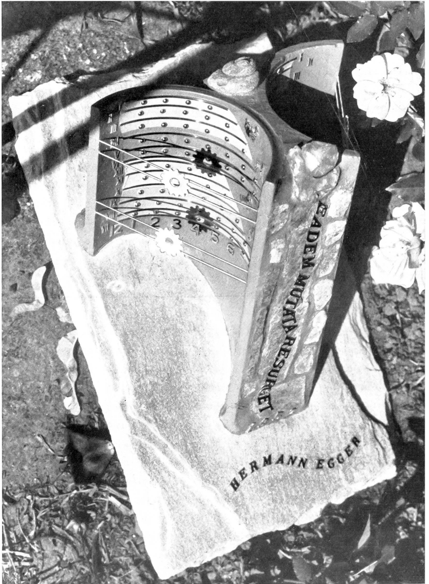
Abb. 5. Gnomonische Doppelzylinder-Sonnenuhr. (Erfindung von H. Egger)
