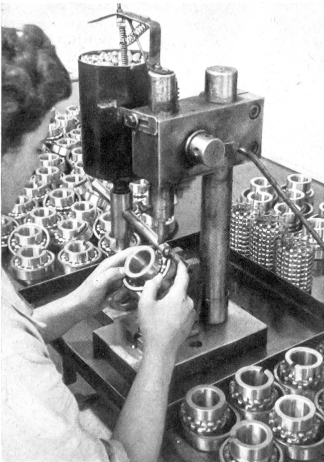
Einfüllen der Kugeln in Pendelkugellager
