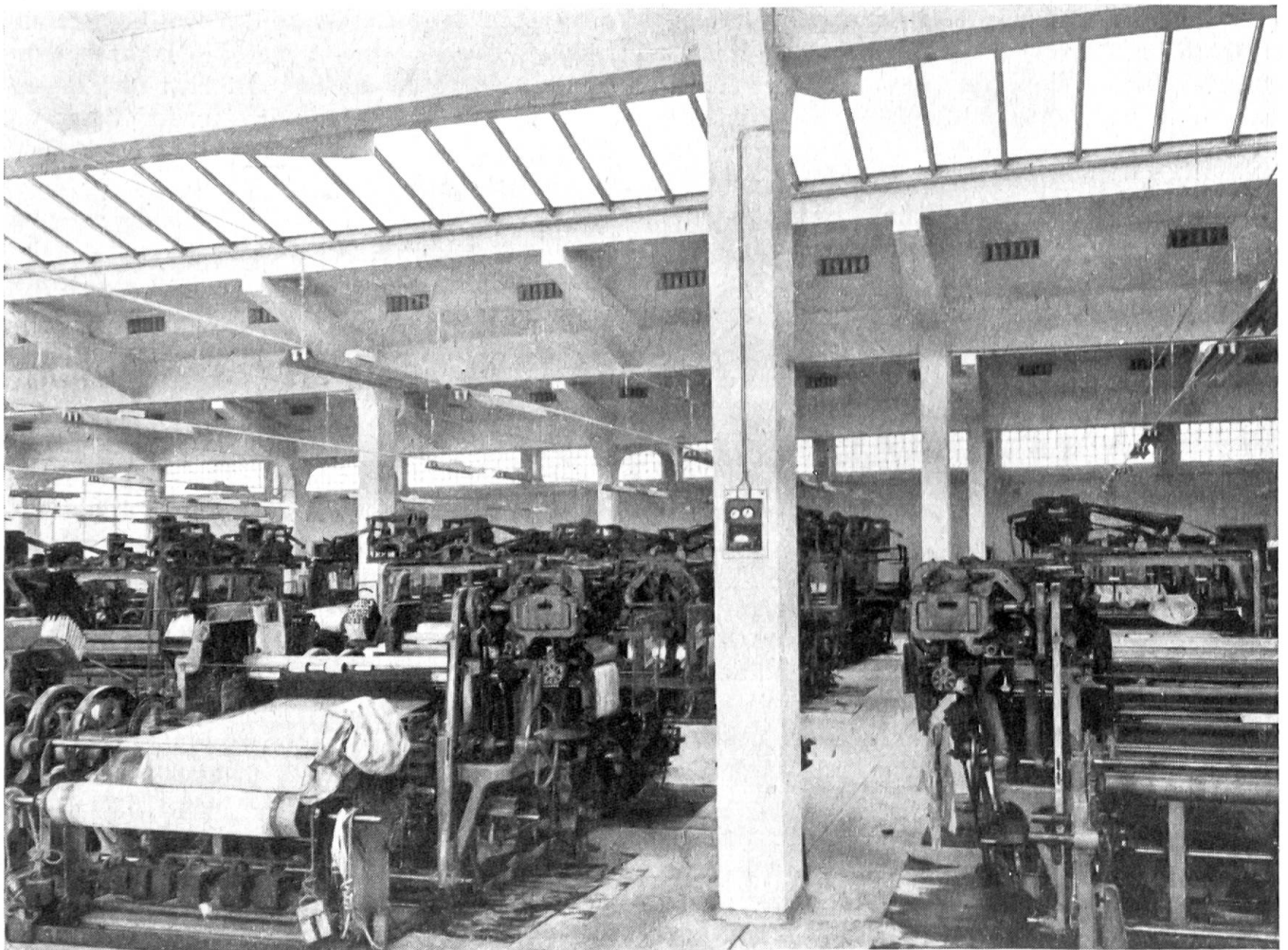
Abb. 1. Luftverteilkapüle in einem klimatisierten Websaal. Auf der Säule in Bildmitte ist der die Raumluftfeuchtigkeit regelnde Hygrostat sichtbar
