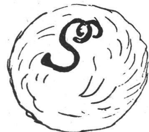
Contrappeso di pietra con manubrio di ferro
