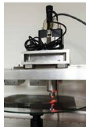
Le système VisualAudio scanne les disques endommagés et en rétablit le son. (Photo: Miriam Bolliger Cavaglieri)
