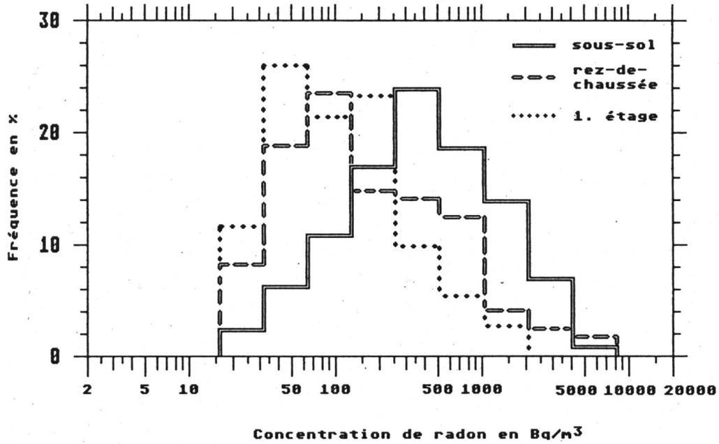
Fig.2.14: Valeurs mesurées de radon à La Chaux-de-Fonds (hiver 88/89)
