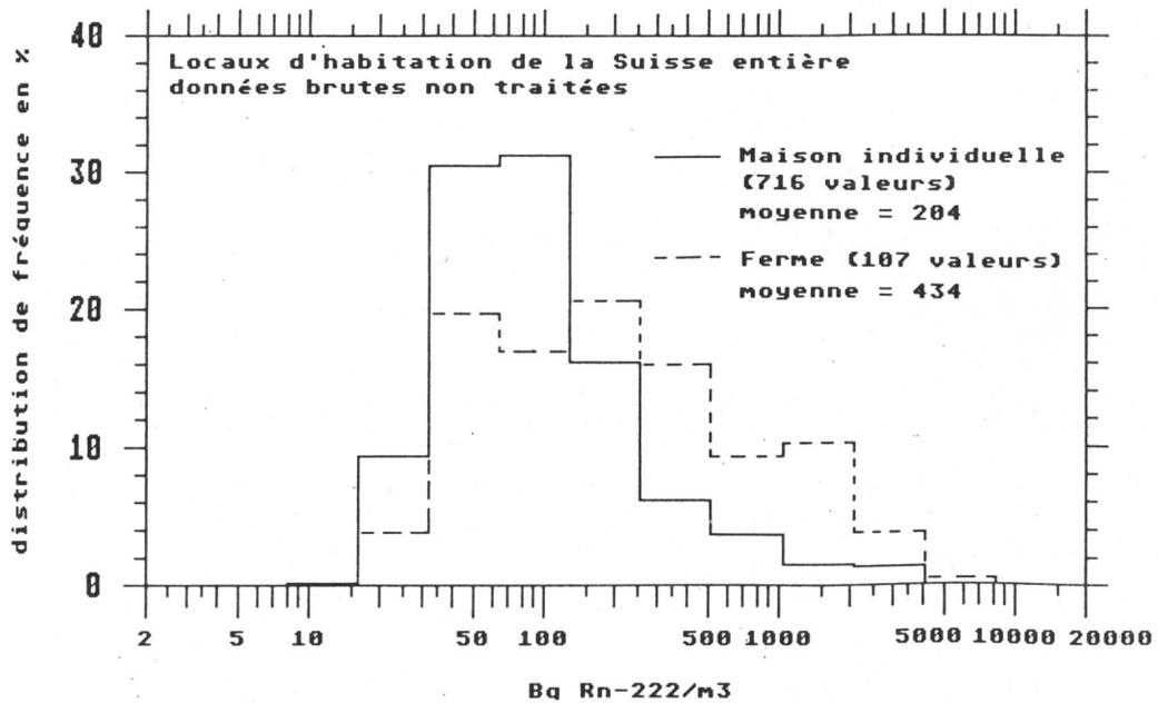
Fig.2.2.a: Valeurs de radon mesurées jusqu'à l'hiver 88/89 inclu
