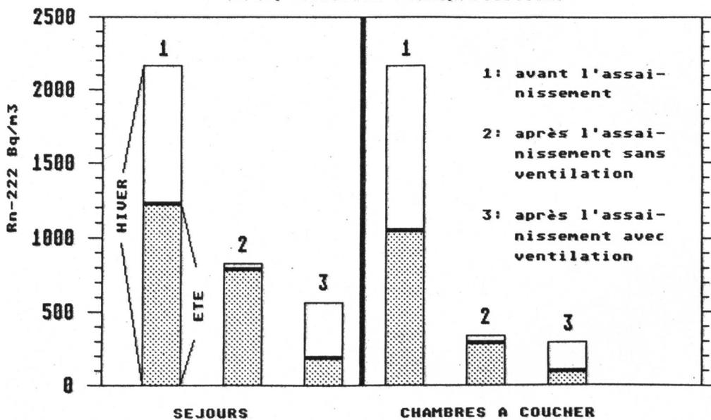
Fig.2.9: Valeurs mesurées de radon à La Chaux-de-Fonds (hiver 88/89)
