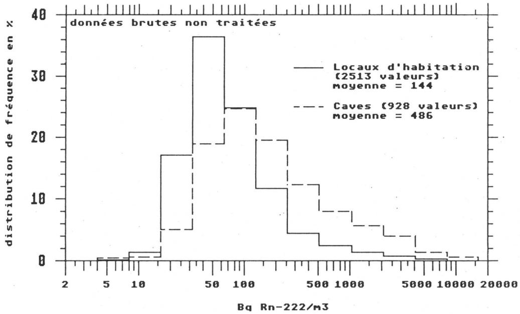
Fig.2.1.b: Valeurs de radon mesurées jusqu'à l'hiver 88/89 inclu
