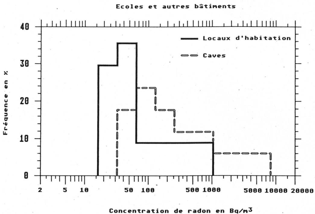
Fig.2.13: Valeurs mesurées de radon à La Chaux-de-Fonds (hiver 88/89)
