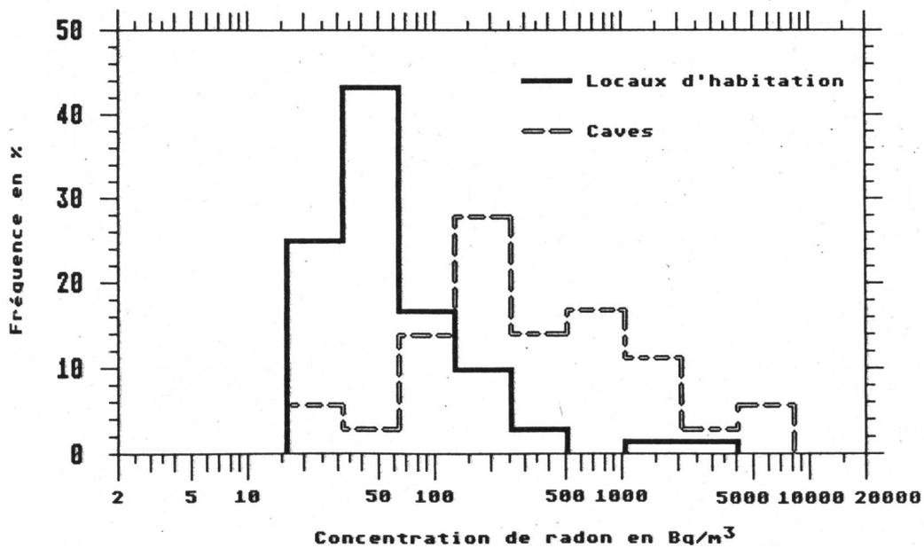
Fig.2.11: Valeurs mesurées de radon à La Chaux-de-Fonds (hiver 88/89)
