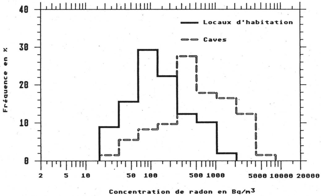
Fig.2.10: Valeurs mesurées de radon à La Chaux-de-Fonds (hiver 88/89)
