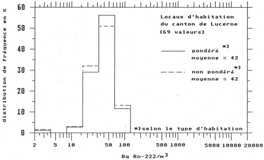
Fig.2.3.b: Valeurs de radon mesurées jusqu'à l'hiver 88/89 inclu
