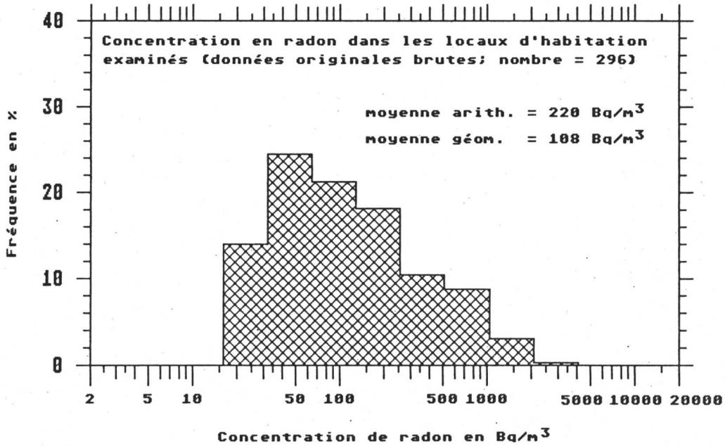
Fig.2.16: Valeurs mesurées de radon à La Chaux-de-Fonds (hiver 88/89)
