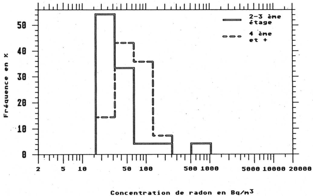
Fig.2.15: Valeurs mesurées de radon à La Chaux-de-Fonds (hiver 88/89)
