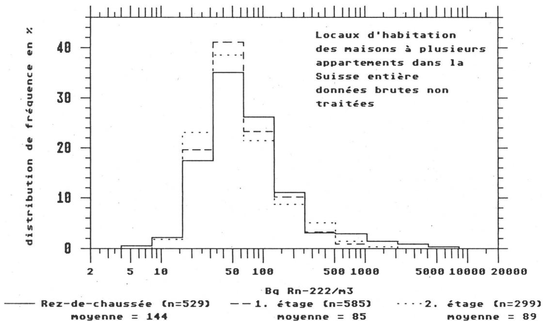
Fig.2.2.b: Valeurs de radon mesurées jusqu'à l'hiver 88/89 inclu
