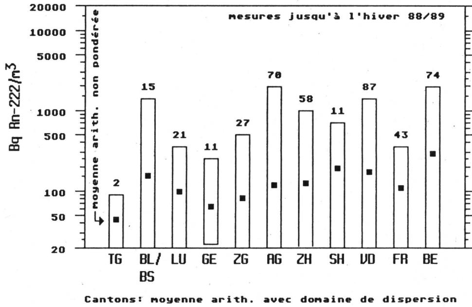
Fig.2.5.b: Mesure de radon dans les caves
