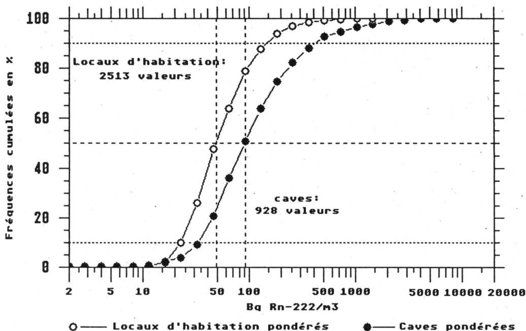
Fig. 2.6.b: Concentrations de radon jusqu'à l'hiver 88/89 inclu
