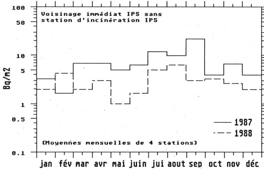
Fig.4.18: Activité bêta totale déposée sur les plaques de vaseline
