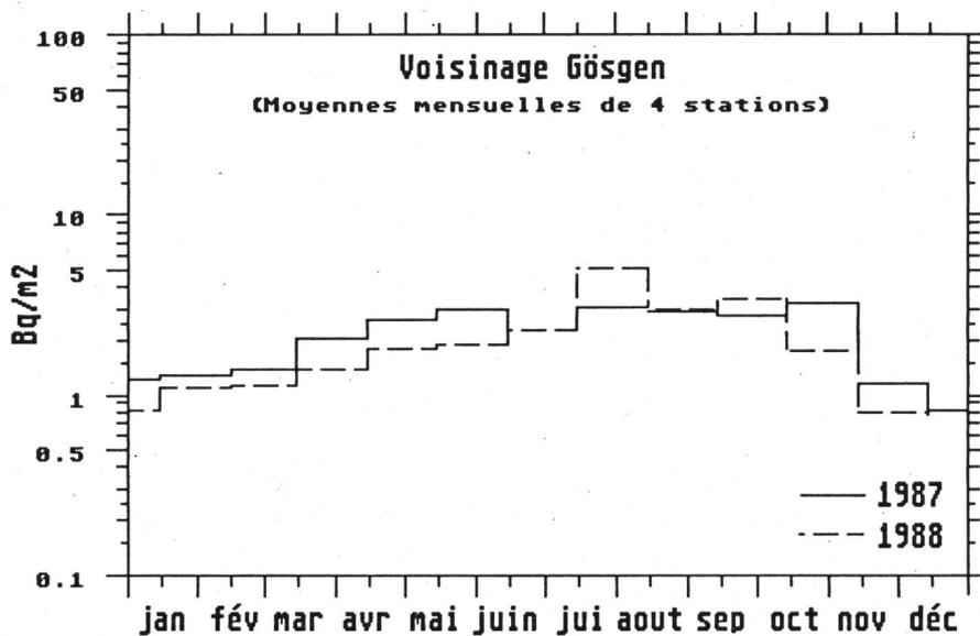
Fig.4.16: Activité bêta totale déposée sur les plaques de vaseline
