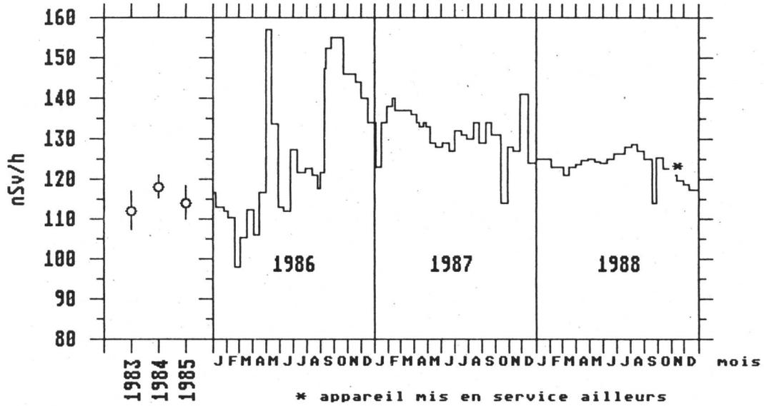
Fig. 4.8: Débit d'exposition externe mesuré à l'aide d'une chambre à ionisation NIEDERRUNTIGEN CNM-SCHALTZENTRALE (VOISINAGE CNM)
