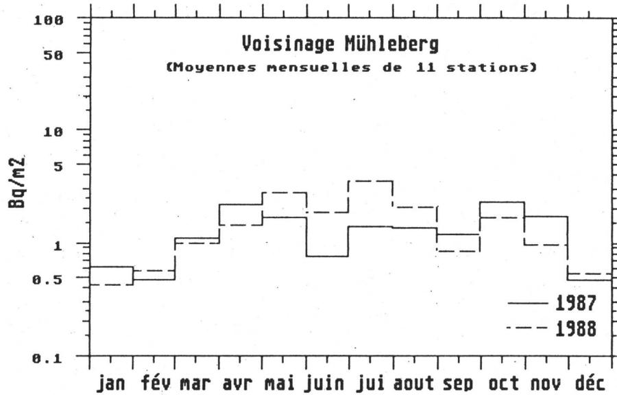
Fig.4.20: Activité bêta totale déposée sur les plaques de vaseline
