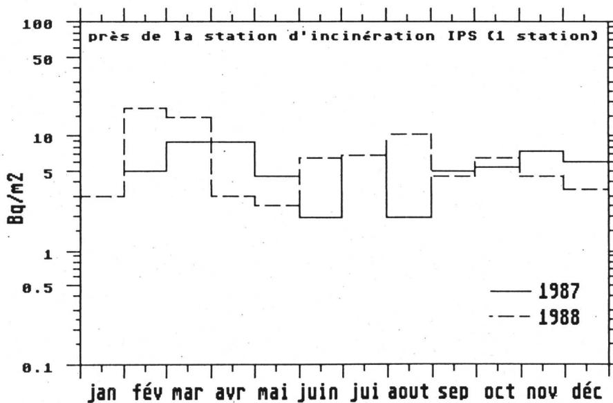
Fig.4.19: Activité bêta totale déposée sur les plaques de vaseline
