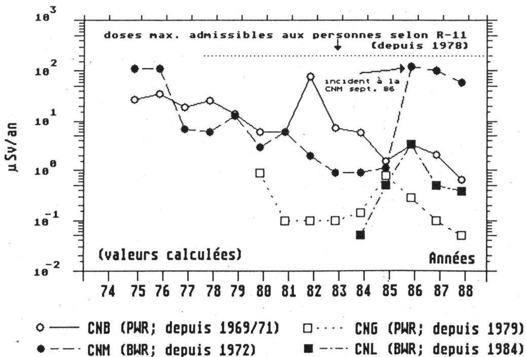
Fig. 4.7: Débit d'exposition externe mesuré à l'aide d'une chambre à ionisation UFEM HORN (VOISINAGE CNM)
