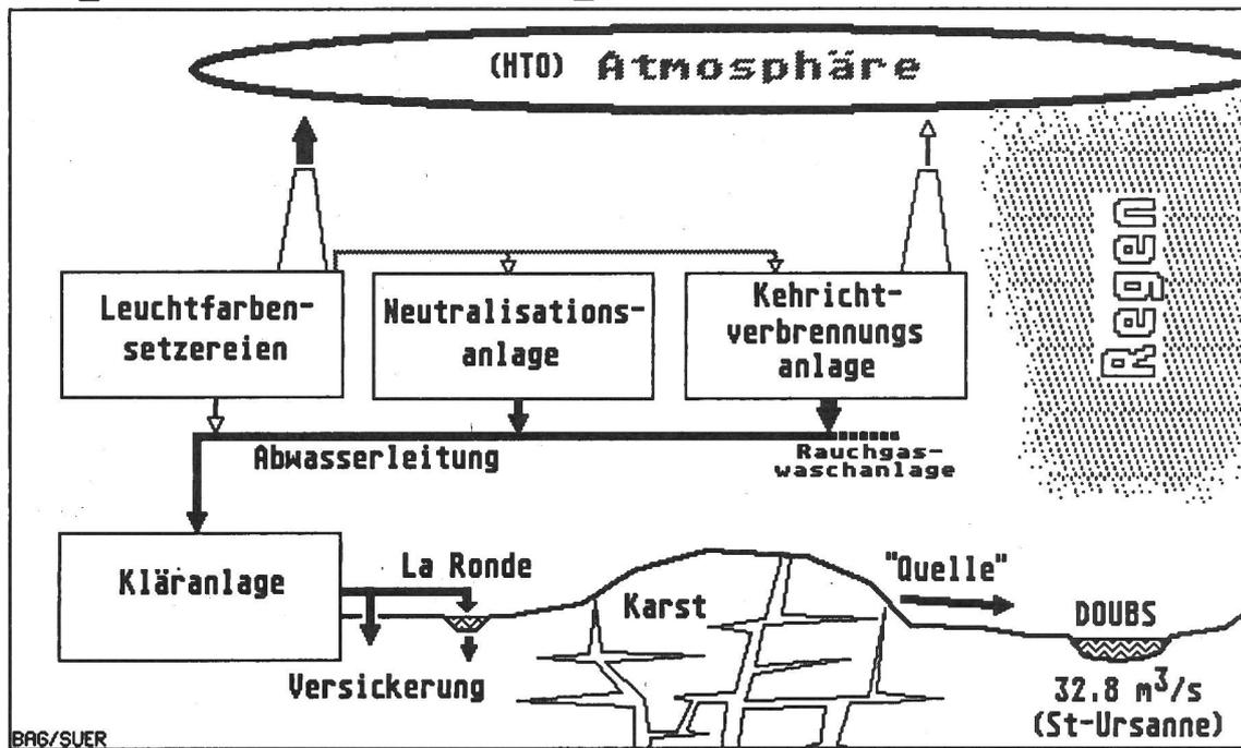
Fig.2: Tritium-Fliessschema La Chaux-de-Fonds
