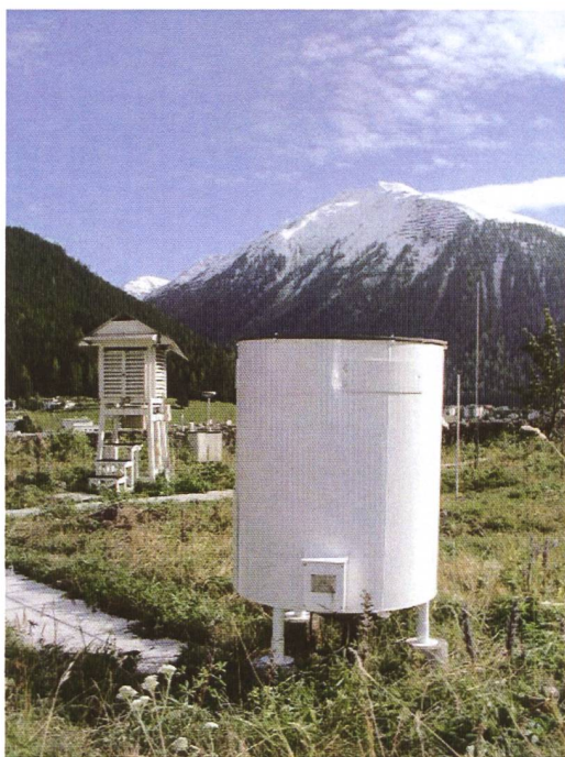
Photo 1: Pluviomètre près de Davos (GR)
