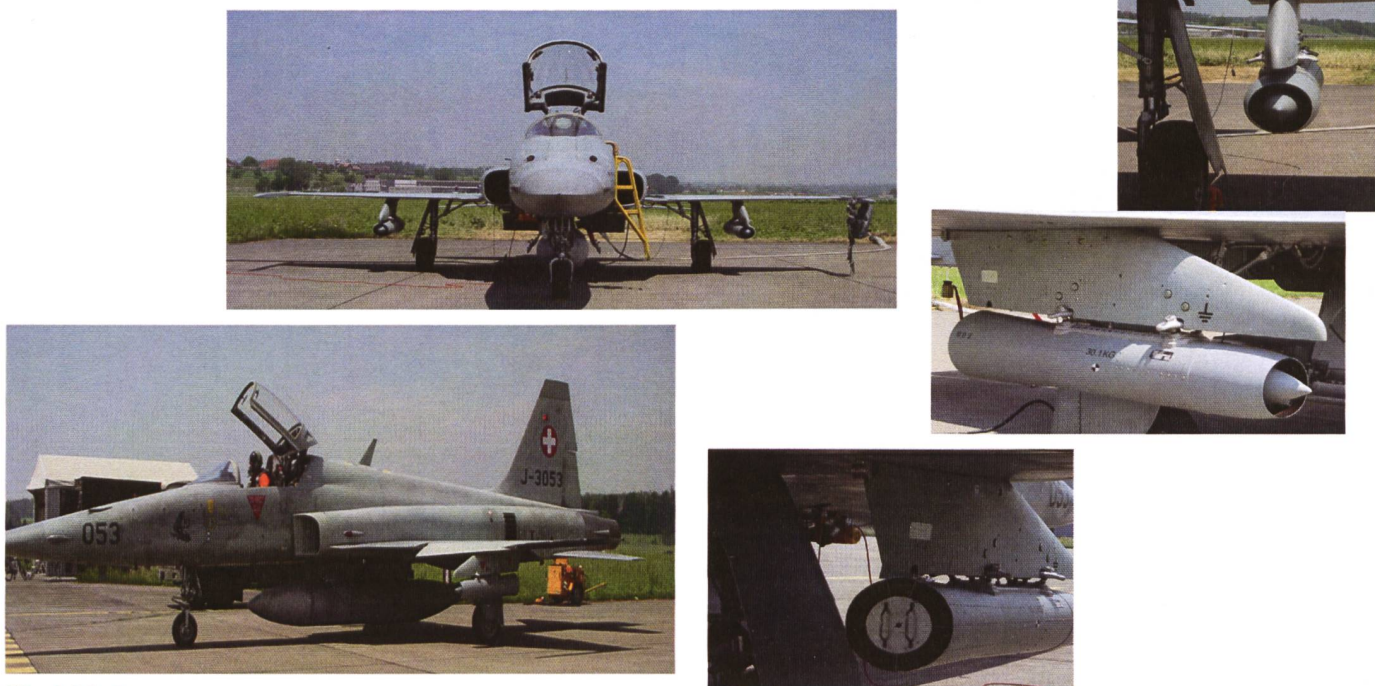
Fig. 2 bis 7: Höhenluftfilter-Aggregate montiert an den beiden Flügeln eines Tiger (F5 E/F)-Flugzeuges der Schweizer Luftwaffe auf dem Militärflugplatz Payerne sowie Detail-Aufnahmen (von vorne und hinten) eines Sammelgerätes.
