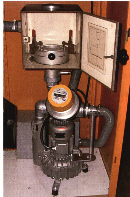
Photo 2: Collecteur d'aérosols de Locarno-Monti: boîte à filtres ouvertes, dessous mesure du débit et pompe
