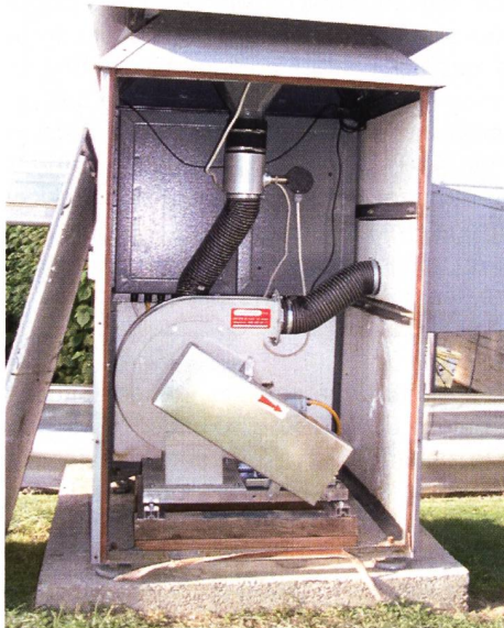
Photo 3: Collecteur d'aérosols à grand débit de Güttingen/TG (500 à 700 m 3 /h; type ASS-550)
