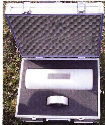
Figur 9: Set für Sondentest: Plastikzylinder, Quelle.
