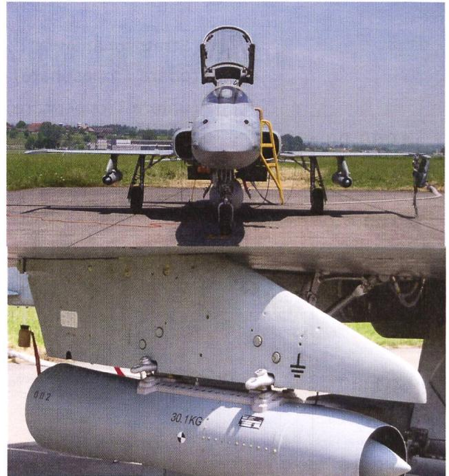
**Figur 2:** Höhenluftfilter-Aggregate montiert an den beiden Flügeln eines Tiger sowie Detail-Aufnahme eines Sammelgerätes.
