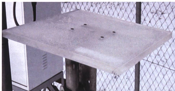
Figur 1: Staubfangplatte am Zaun des ZWILAG-Areals.
