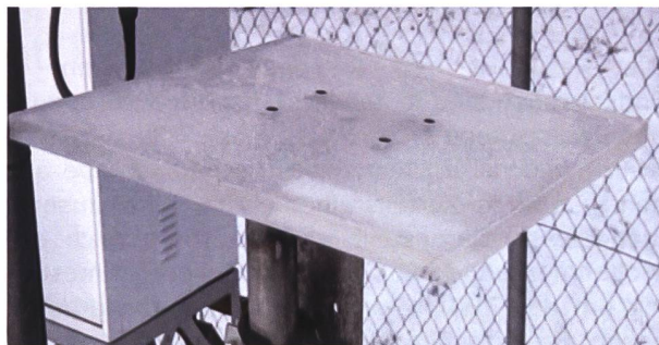
Figur 1: Staubfangplatte am Zaun des ZWILAG-Areals.
