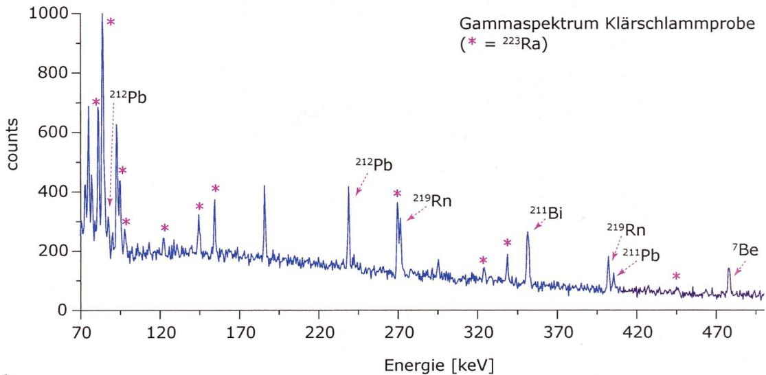
**Figur 1:** Gammaspektrum einer Klärschlammprobe mit  $^{223}\text{Ra}$  aus einer kleinen Kläranlage (4.4.2013). Die  $^{223}\text{Ra}$  Peaks sind mit einem Asterisk gekennzeichnet. Zur  $^{223}\text{Ra}$  Zerfallsreihe gehören auch  $^{219}\text{Rn}$ ,  $^{211}\text{Pb}$  und  $^{211}\text{Bi}$ . Nicht-beschriftete Peaks gehören zum Untergrund.
