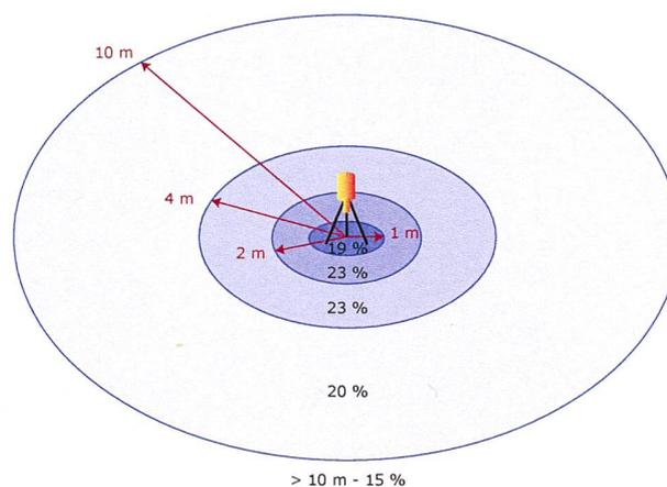
**Figure 2:** «Champ de vision» d'un spectromètre gamma in situ installé 1 m au-dessus du sol. Les [%] indiquent dans quelle mesure les émetteurs  $\gamma$  se trouvant dans chacune des zones représentées contribue au signal total enregistré. Par exemple, 20% des photons détectés proviennent de la zone située entre 4 m et 10 m.
