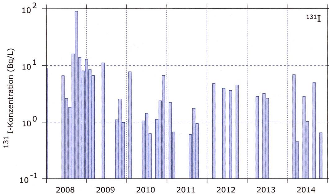
**Figur 4:** Concentrations de <sup>131</sup>I (Bq/l) enregistrées dans les eaux de lavage des fumées de l'usine d'incinération de Hagenholz de 2008 à 2014 (prélèvement et analyse effectués par l'EAWAG).
