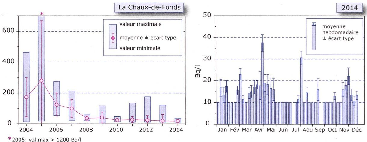
**Figure 3 :** Concentrations du tritium mesurées dans les eaux de la station d'épuration de La Chaux-de-Fonds entre 2004 et 2014.
