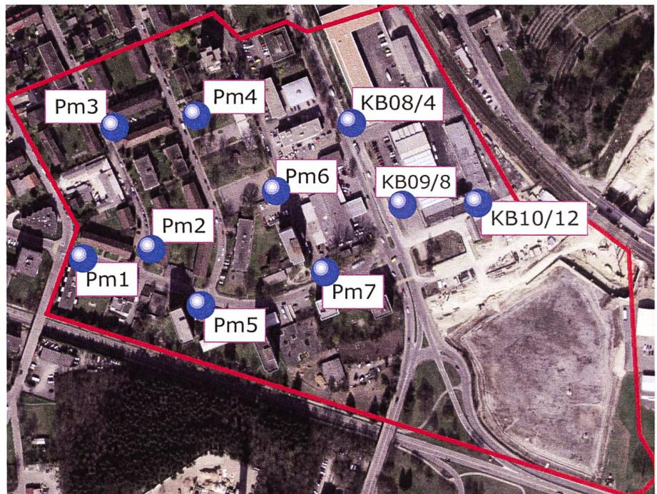
**Figur 2:** Standorte der Piezometer (Pm) und der Kernbohrungen (KB) in der ehemaligen Deponie Lischenweg (rote Linie). Karte: Swisstopo (map.admin.ch)
