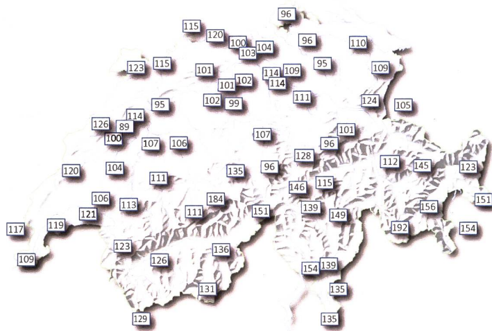
Figur 2: Karte der Jahresmittelwerte 2016 aller NADAM-Sonden in Nanosievert pro Stunde, basierend auf den 10-Min-Werten. Der Jahresmittelwert der Ortsdosisleistung variiert je nach Standort zwischen 89 und 192 nSv/h.
