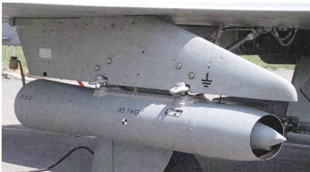
Figur 2: Höhenluftfilter-Aggregate: Detail-Aufnahme eines Sammelgerätes.
