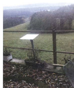
Figur 1 : Staubfangplatte am Lorbeerbusch
