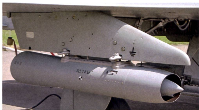
Figur 2 : Höhenluftfilter-Aggregate: Detail-Aufnahme eines Sammelgerätes.
