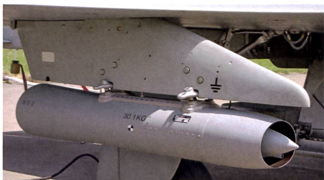
Figur 2 : Höhenluftfilter-Aggregate: Detail-Aufnahme eines Sammelgerätes.
