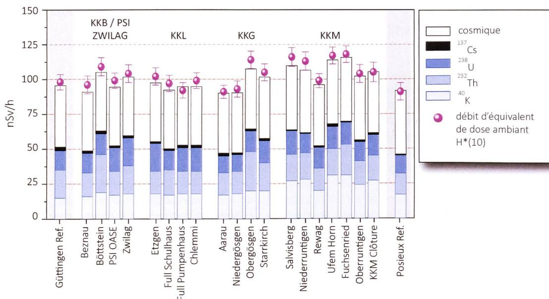
**Figure 1 :** Contributions individuelles au débit d'équivalent de dose ambiant  $H^*(10)$  calculées à partir des spectres in situ (distribution supposée homogène des radionucléides dans le sol) mesurés au voisinage des centrales nucléaires suisses en 2019 ainsi qu'aux points de référence de Güttingen/TG et Posieux/FR (en grisé). La mesure globale du débit d'équivalent de dose ambiant  $H^*(10)$  avec chambre d'ionisation est également représentée.
