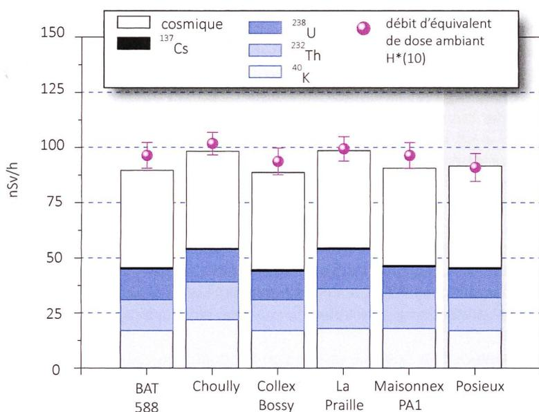
**Figure 3:** Contributions individuelles au débit d'équivalent de dose ambiant  $H^*(10)$  calculées à partir des spectres in situ (distribution supposée homogène des radionucléides dans le sol) mesurés en 2019 au voisinage du CERN ainsi qu'au point de référence de Posieux (en grisé). La mesure globale du débit d'équivalent de dose ambiant  $H^*(10)$  avec chambre d'ionisation est également représentée.
