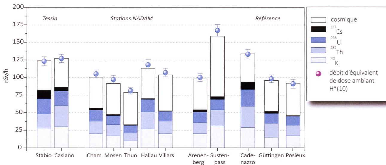
**Figure 4:** Contributions individuelles au débit d'équivalent de dose ambiant  $H^*(10)$  calculées à partir des spectres in situ (distribution supposée homogène des radionucléides dans le sol) mesurés en 2019 au Tessin, aux cinq nouvelles stations NADAM, à Arenenberg et au col du Susten ainsi que sur les trois sites de référence. La mesure globale du débit d'équivalent de dose ambiant  $H^*(10)$  avec chambre d'ionisation est également représentée.
