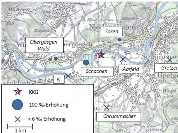
**Figur 4:** Örtliche Verteilung der Netto  $\Delta^{14}\text{C}$ -Werte in der Umgebung des Druckwasserreaktors Gösgen (KKG). Revisionsabschaltung: 06.06.2020 bis 24.06.2020. Probenahme: 24.06.2020. Die Kreisflächen sind proportional zur Erhöhung gegenüber den unbelasteten Referenzstationen.
