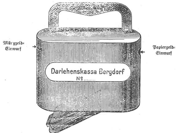
Die Kassette ist aus einem Stück Stahlblech von 2 mm Dicke nahtlos gezogen, oxydiert und verziert. Türchen zum Herausnehmen der Spargelder unten. Auf der einen Seite „Schütz mit automatischem Verschluß“ zum Geldeinwurf. Auf der andern Seite ein rundes Loch zum Einstecken von Papiergeld. Sicherheitschloß mit 3 Zuhaltungen und Flachschlüssel.
