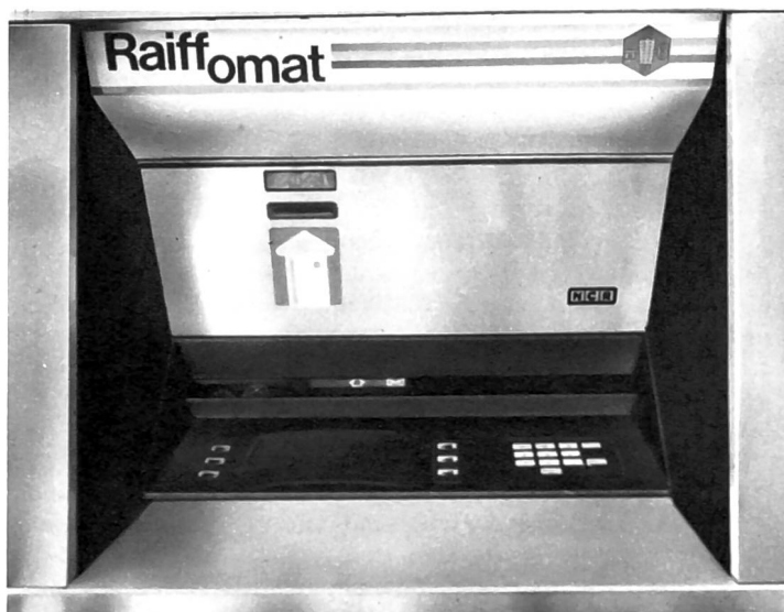
NCR-Raiffomat bei der Zentralbank in St. Gallen: Er wird auf das Bancomat-85-System umgerüstet werden.
