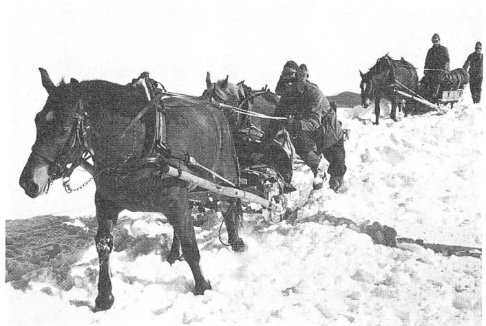
Der gebrochene und gefestigte Ruttnernpfad wird mit Schlitten transportiert, deren Kufen man quer mit einer Kette verbindet.
