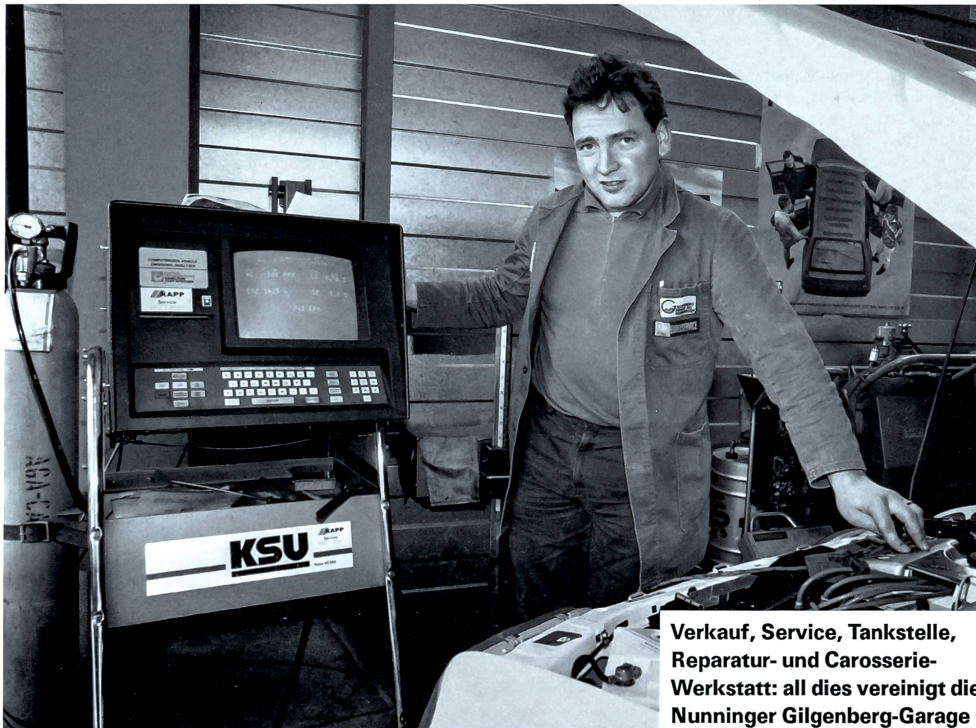
Hansruedi Müller beim Abgastest. Das Testgerät kostet rund 20 000 Franken und muss nach fünf, spätestens aber nach acht Jahren ersetzt werden.
