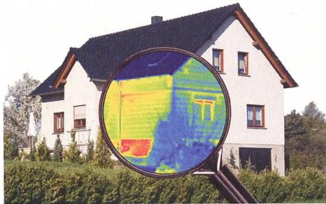
Das Infrarotfoto zeigt die für das menschliche Auge unsichtbaren Infrarotstrahlen und deckt auf, wo ein Gebäude Wärme verliert: warme Stellen sind weiss, gelb bis rot, kalte Stellen in Blautönen.
