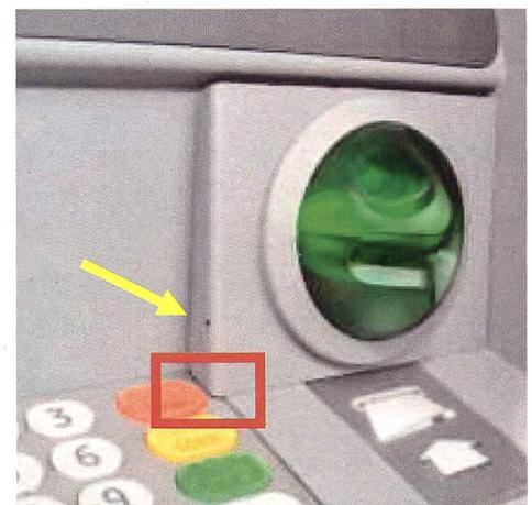
3 Skimming-Aufsatz mit installierter Minikamera bei neuem NCR-Gerät zur Aufzeichnung der Tastenkombination.
