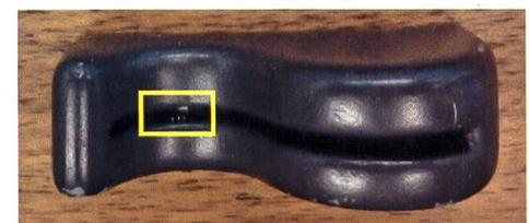
Dieser Skimming-Aufsatz mit Magnet-spurleser (gelb) wurde bei einem älteren NCR-Modell angebracht und später beschlagnahmt.
