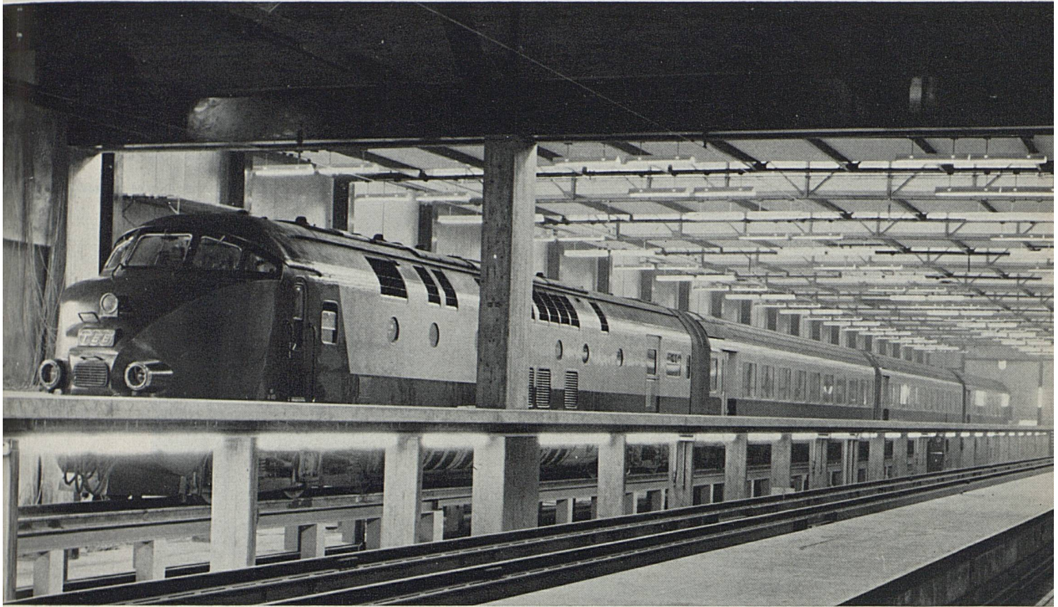
Moderne et confortable, la rame TEE a pénétré dans la nouvelle halle du dépôt de Zurich, où elle sera l'objet de soins attentifs. Grâce à la plateforme surélevée, les ouvriers peuvent travailler rationnellement à deux niveaux différents.
