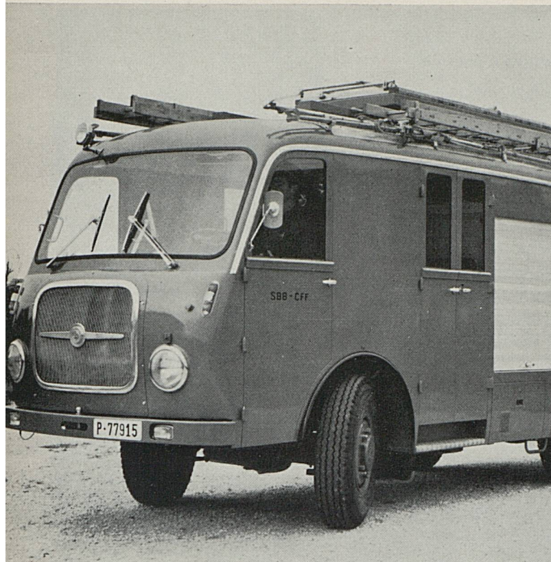
Prototype de fourgon de montage rail-route pour l'entretien des lignes de contact. Il n'est pas prévu de généraliser l'emploi de ce
