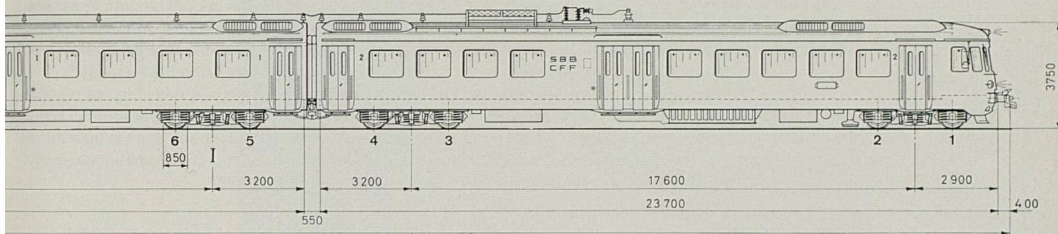
Nouvelle automotrice triple pour le service de banlieue Zurich-Meilen-Rapperswil (entraînement direct de tous les essieux, équipement électronique de commande, attelage automatique permettant de réunir jusqu'à 12 éléments pour la marche en unités multiples).
