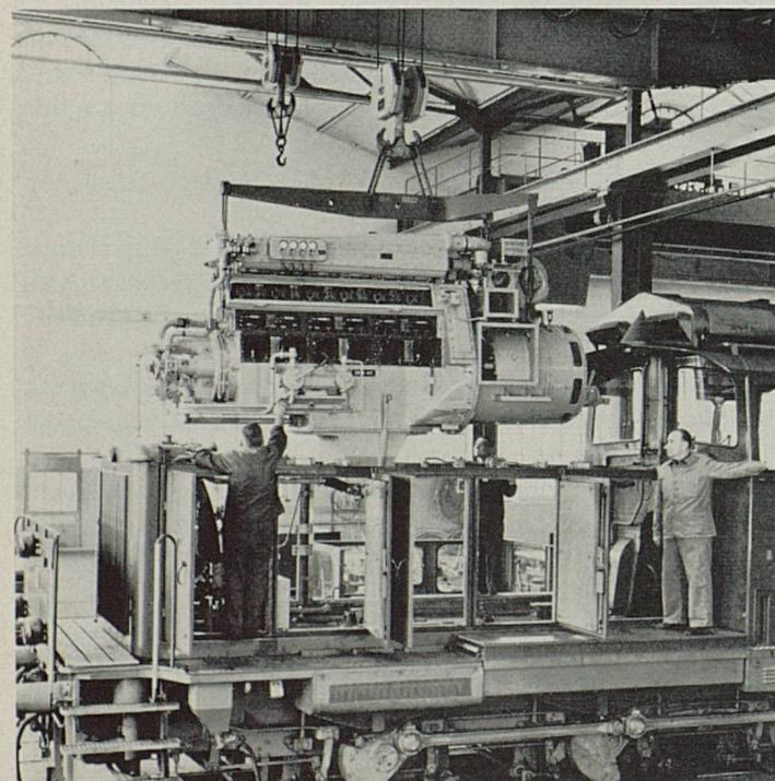
Montage d'un groupe diesel-électrique complet sur une locomotive après la marche d'essai. Une fois équipée, la locomotive passera sur le banc pour un ultime contrôle.
