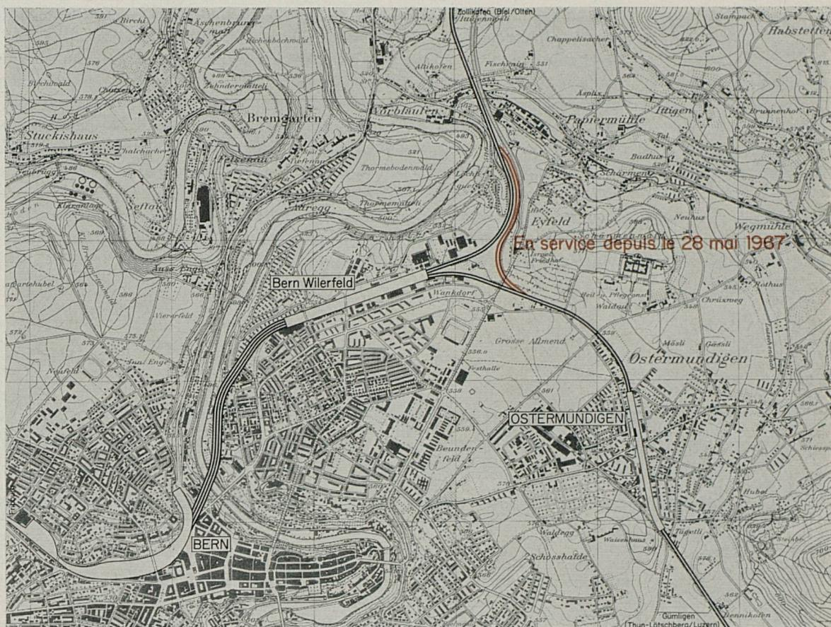
Depuis l'ouverture de la ligne de raccordement à double voie Zollikofen–Ostermündigen, en mai 1967, il est possible d'éviter la gare de Berne sans rebroussement, ce qui facilite beaucoup la circulation des trains en transit passant par Otten et Bienne en direction du Lötschberg et du Simplon.
