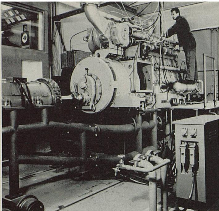
Le moteur diesel d'une locomotive Em 3/3 et son générateur principal sont installés sur le cadre de montage et préparés en vue de l'essai. À gauche, le générateur d'excitation et le générateur auxiliaire sont sur un autre cadre. Les radiateurs d'eau et d'huile se trouvent au sous-sol.
