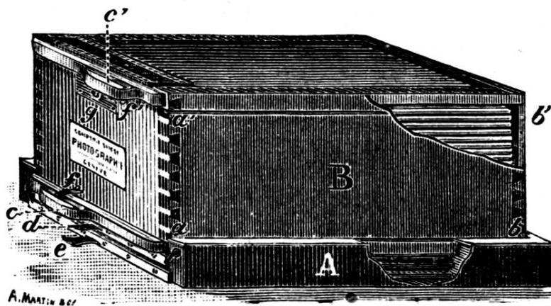
*a' b'*. Le magasin est garni de porte-plaques en tôle dans lesquels les plaques sont placées, la couche en dehors.
