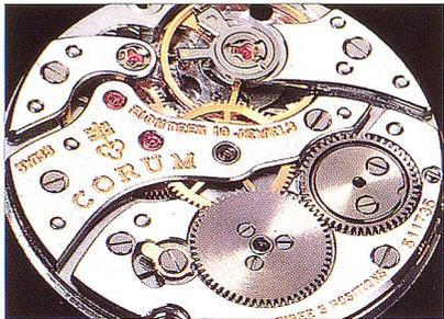
Das ultraflache Handaufzugswerk (Höhe 1,75 mm), das zwischen die beiden Hälften der Goldmünze eingebaut wird.
