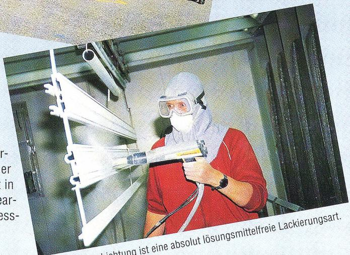
Die Pulverbeschichtung ist eine absolut lösungsmittelfreie Lackierungsart.
