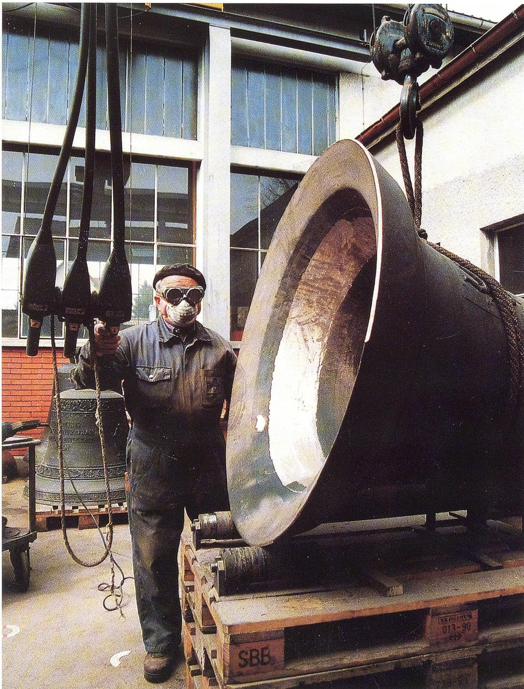
Immer wieder muss mit Hilfe des Kranens die Position der Glocke verändert werden, damit der Schliff auf allen Seiten vorgenommen werden kann.
