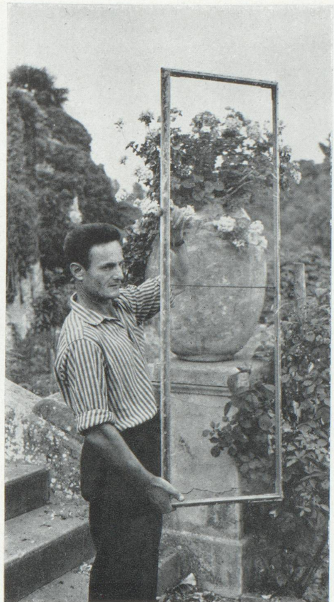
Transparence du film de Rislan : Le film de Rislan est tendu sur un châssis métallique. La photo rend très bien la transparence extraordinaire du film de Rislan (Alpes-Maritimes 1958). (Document « Industrie des plastiques modernes ».)
