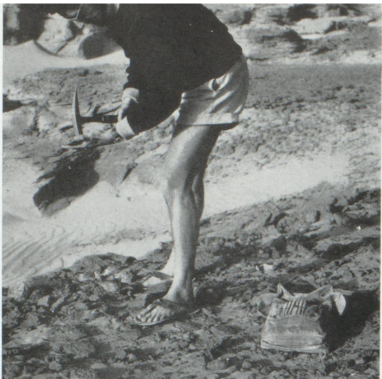
Le géologue casse au marteau des fragments de roches afin d'obtenir une cassure fraîche lui permettant de déterminer exactement leur nature (Cliché B.R.P.)
