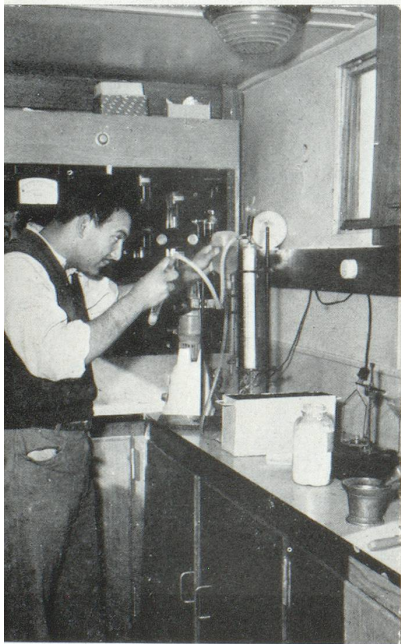
◀ Opération de mesure de la proportion de calcaire dans les déblais au calcimètre Bernard (Cliché B. R. P.)
