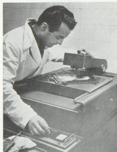
1 heure du matin, René Meyniel, opérateur de nuit, grave en quelques minutes une « dernière heure », cliché en alliage léger réalisé sur le clichographe électronique du journal
