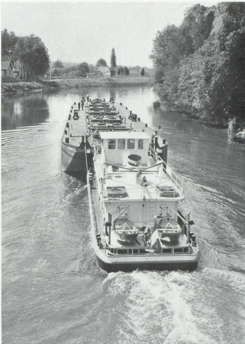
La nouvelle technique du « poussage » vient des Etats-Unis où elle est utilisée depuis longtemps. Ici le premier convoi poussé arrivé à Bâle.
