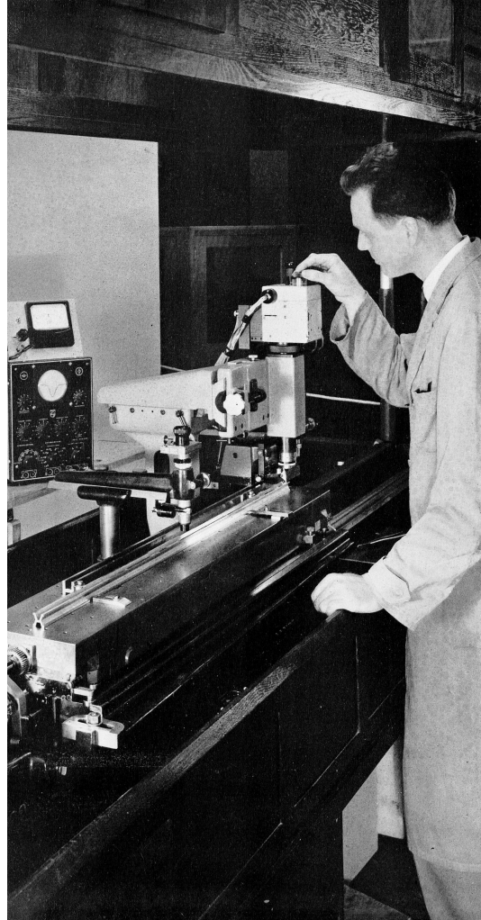
A gauche : Redivivage d'un mètre-prototype sur machine à diviser de la Société d'Instruments de Physique de Genève. C-dessus : Contrôle au 1/1000 mm d'une plaque de combre. Machine à injection pour les matières thermoplastiques (Paillard).
