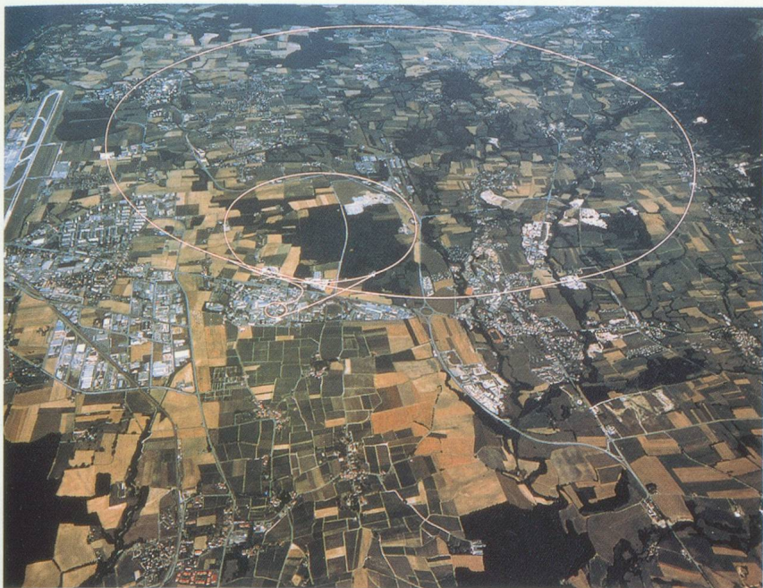
Vue aérienne du domaine du CERN. Trois anneaux sont visibles le plus petit indique l'emplacement du PS, le moyen représente le tunnel SPS d'une circonférence de 7 km et le plus grand le tunnel du LEP d'une circonférence de 27 km
