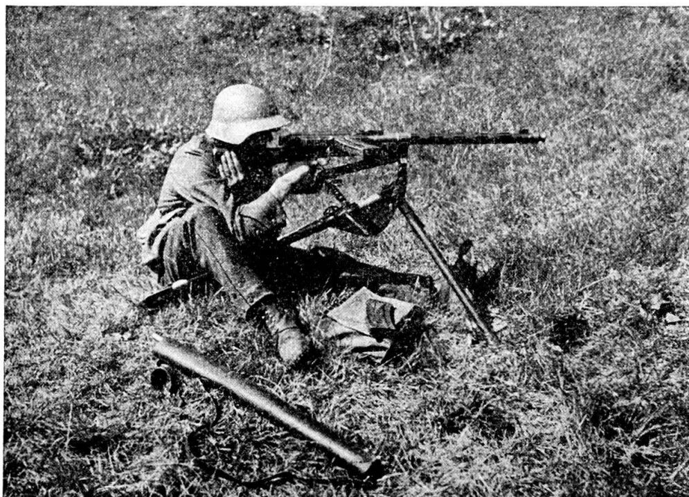
Il nuovo sostegno della m. l. ha esattamente la forma di un treppiede. I piedi anteriori sono facilmente articolabili e si possono spostare in varie posizioni.
