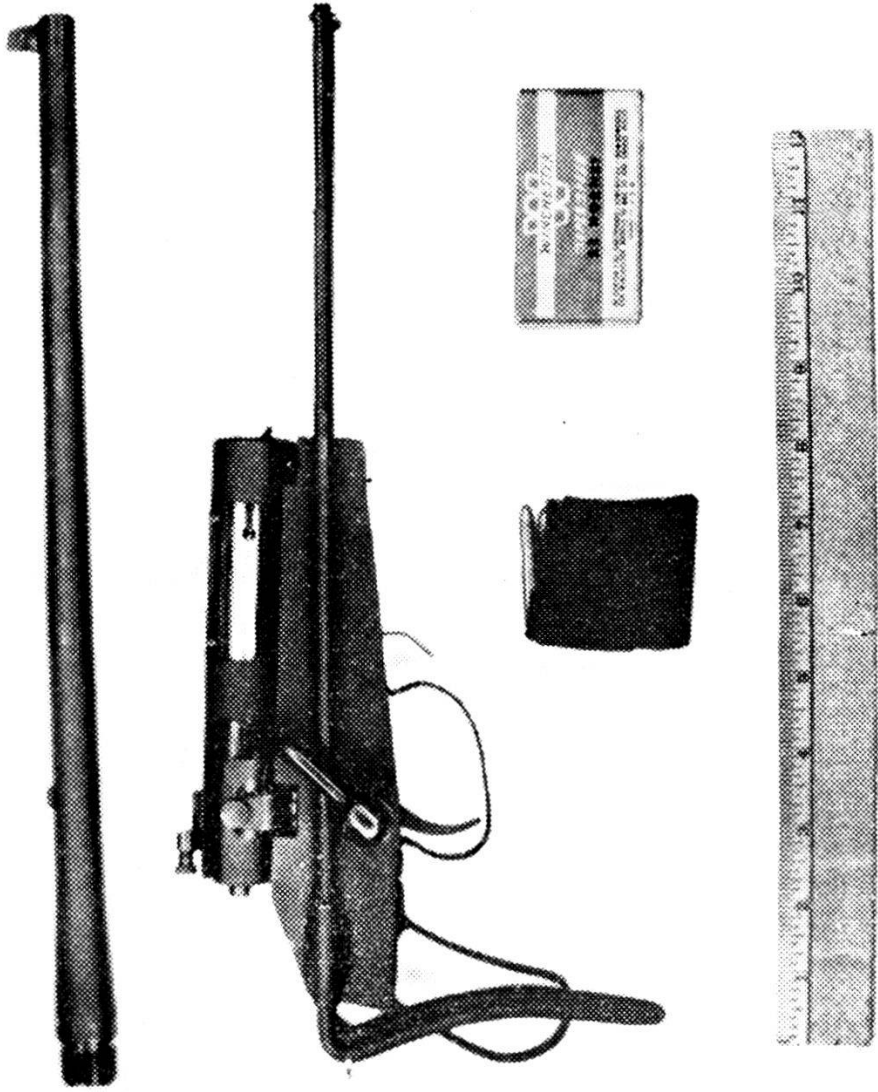
Stati Uniti. Il fucile ripiegabile dell'Aviazione: pronto per il tiro misura 1 metro; ripiegato 35 cm.; peso 1 chilogrammo L'illustrazione mostra l'arma ripiegata.
