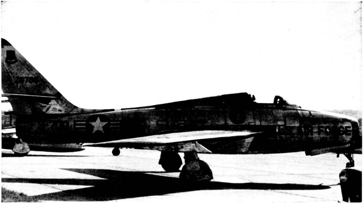
Il « THUNDERSTREAK » F-84 F. Il timone di profondità si presenta applicato al timone di direzione, e le ali sono più mediane che basse. (USA)
